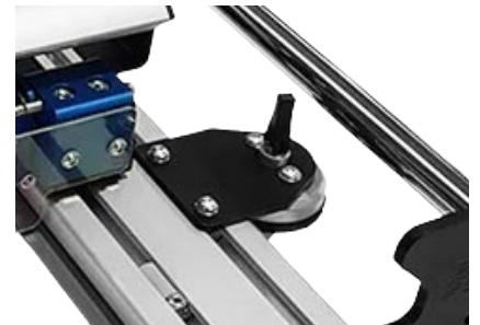
Saugnäpfe zur temporären Befestigung des Pressbalkens auf der Arbeitsplatte
