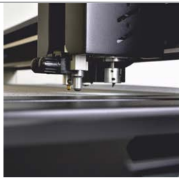
Vierfach-Schneidkopf für schnelles Schneiden und Rillen
