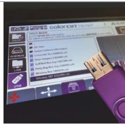
Standalone – kabellose Auftragsverarbeitung von einem USB-Stick
