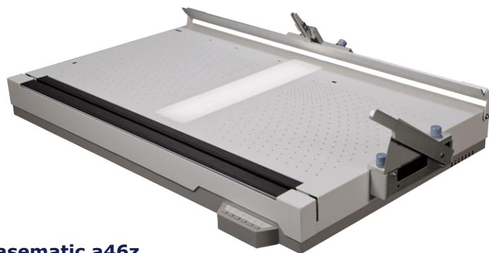
Casematic a46z Kantenfalteinheit mit automatischer Klemmung bis 3,5 mm
